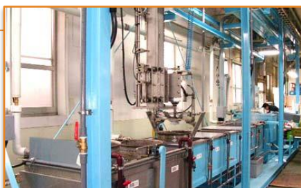
自動アルカリ脱脂装置
